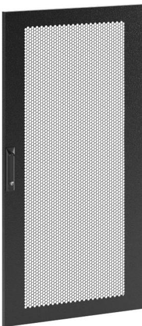
Новые двери имеют перфорацию плотностью 82%. Такая плотность перфорации увеличивает воздухопроницаемость, что, в свою очередь, улучшает охлаждение оборудования, установленного в телекоммуникационном шкафу.
